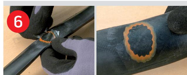
Abschließend transparente Schutzfolie vorsichtig entfernen. Fertig!
