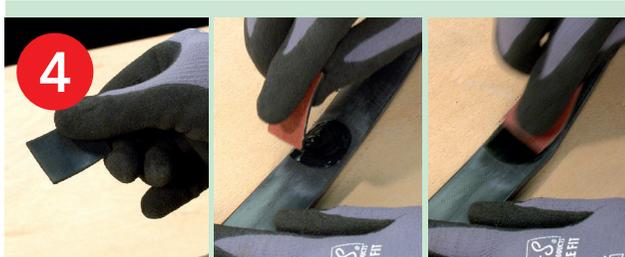
✓ SVS Vulkanisierflüssigkeit 5x kreuzweise leicht verstreichen bis die Flüssigkeit gleichmäßig dünn verteilt ist und noch leicht seidig glänzt.
